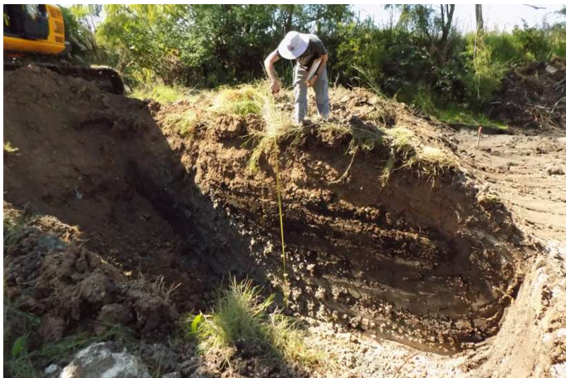
Tareas de registro de perfiles en trinchera de la Brigada de Comunicaciones No. 1.
