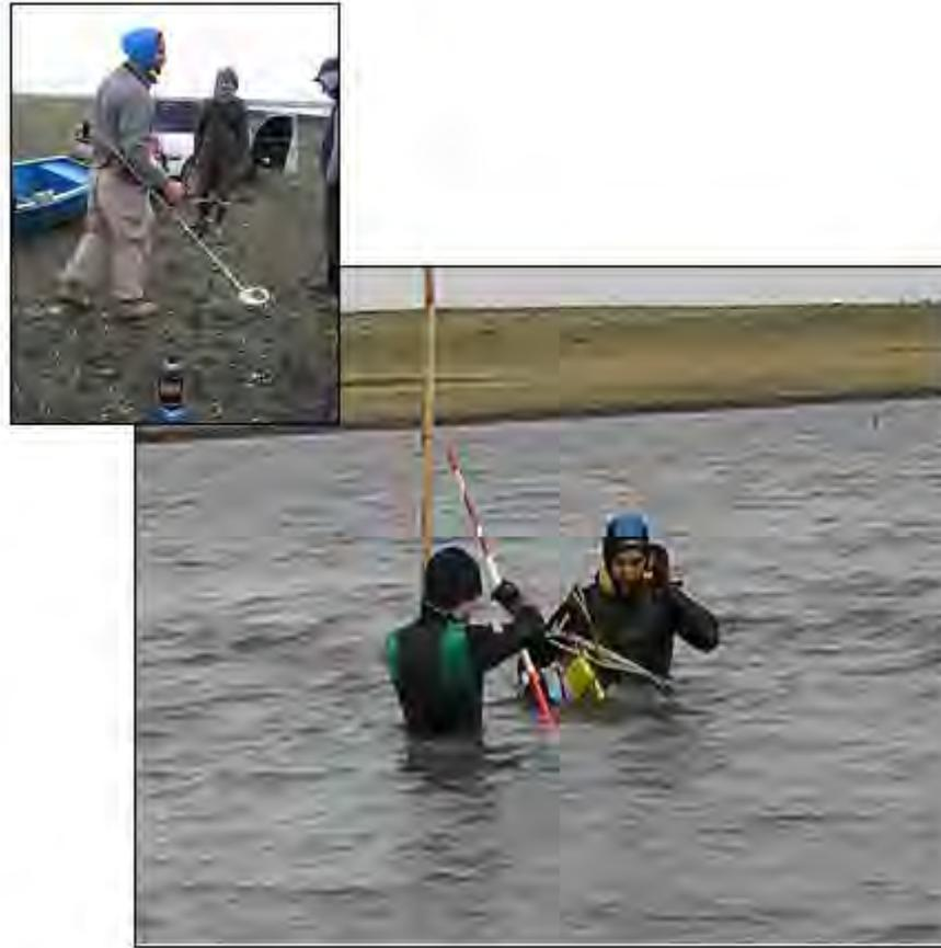
Figura 5. Calibración (arriba) y tareas de prospección subacuática con detector de metales (abajo)
