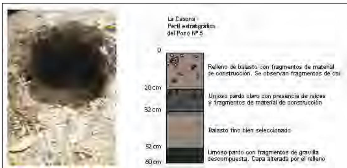
Figura 3. Fotografía y dibujo de perfil estratigráfico pozo N° 5.
