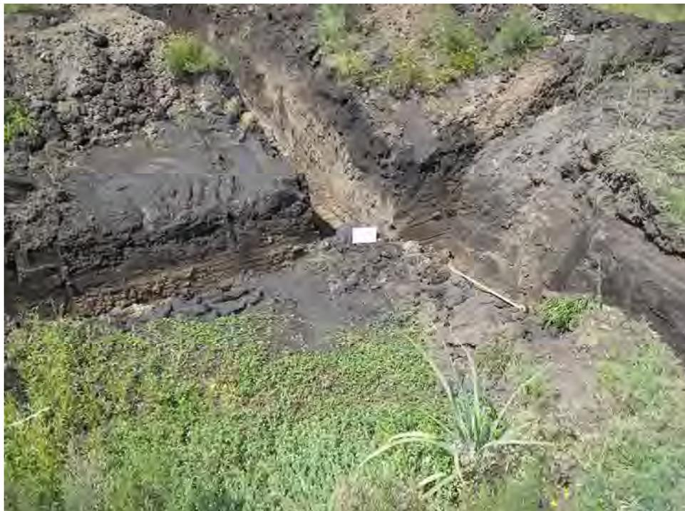
Figura 29. Trincheras ortogonales en el pozo, zona A, donde se aprecia el relleno limoso pardo en la parte superior, en contacto con los horizontes profundos del suelo.
